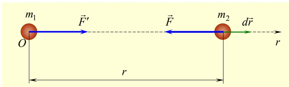
Рис. П12.3. Частица массы  $m_2$  в гравитационном поле частицы массы  $m_1$
