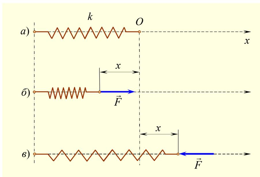
Рис. П12.2. Линейная деформация пружины
